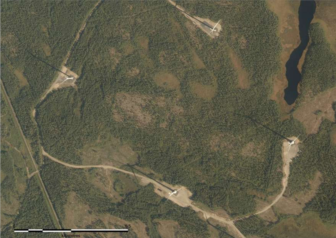
Kuva 79. Ilmakuvasa näkyy toiminnassa olevia tuulivoimaloita. Tuulivoimaloita varten on rakennettu huoltotiet ja nostokentät. Tuulivoimaloiden ympäristössä ja välialueilla aikaisempi maankäyttö on säilynyt ennallaan.
