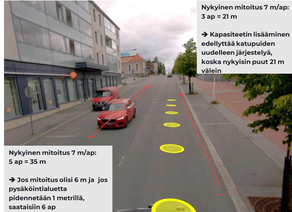
Kuva 14. Esimerkki Riistakadun pysäköintipaikkojen mitoitusmuutoksen vaikutuksista Savonkadun ja Kauppakadun välillä, lähde: Mapspace Viewer .
