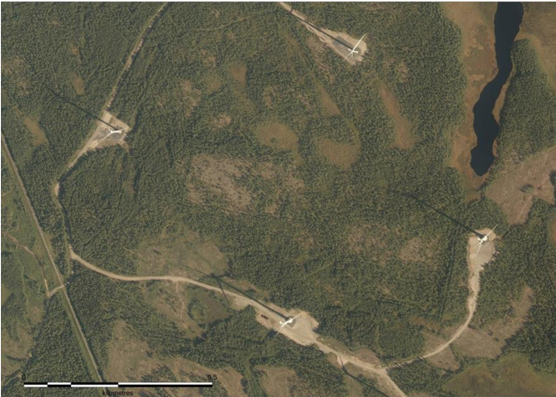
Kuva 86. Ilmakuvassa näkyy toiminnassa olevia tuulivoimaloita. Tuulivoimaloita varten on rakennettu huoltotiet ja nostokentät. Tuulivoimaloiden ympäristössä ja välialueilla aikaisempi maankäyttö on säilynyt ennallaan.
